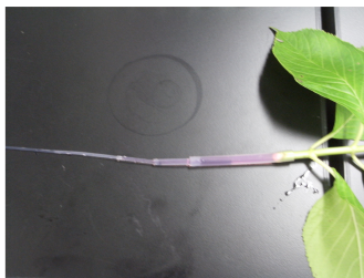
図1 シリコンチューブを用いた吸水量測定法について
